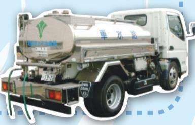
断水地域に対して、運搬給水を行うために、車載式の給水タンクと加圧ポンプ式給水車を備えています。また、運搬能力を増やすため、車載式の加圧給水タンク(2,000リットル)を平成23年度に増台しました。
