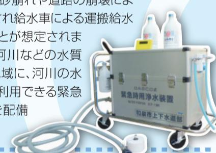
災害による土砂崩れや道路の崩壊により、交通が寸断され給水車による運搬給水が困難になることが想定されます。原水となる河川などの水質が良い市南部地域に、河川の水を飲料水として利用できる緊急時用浄水装置を配備しています。
